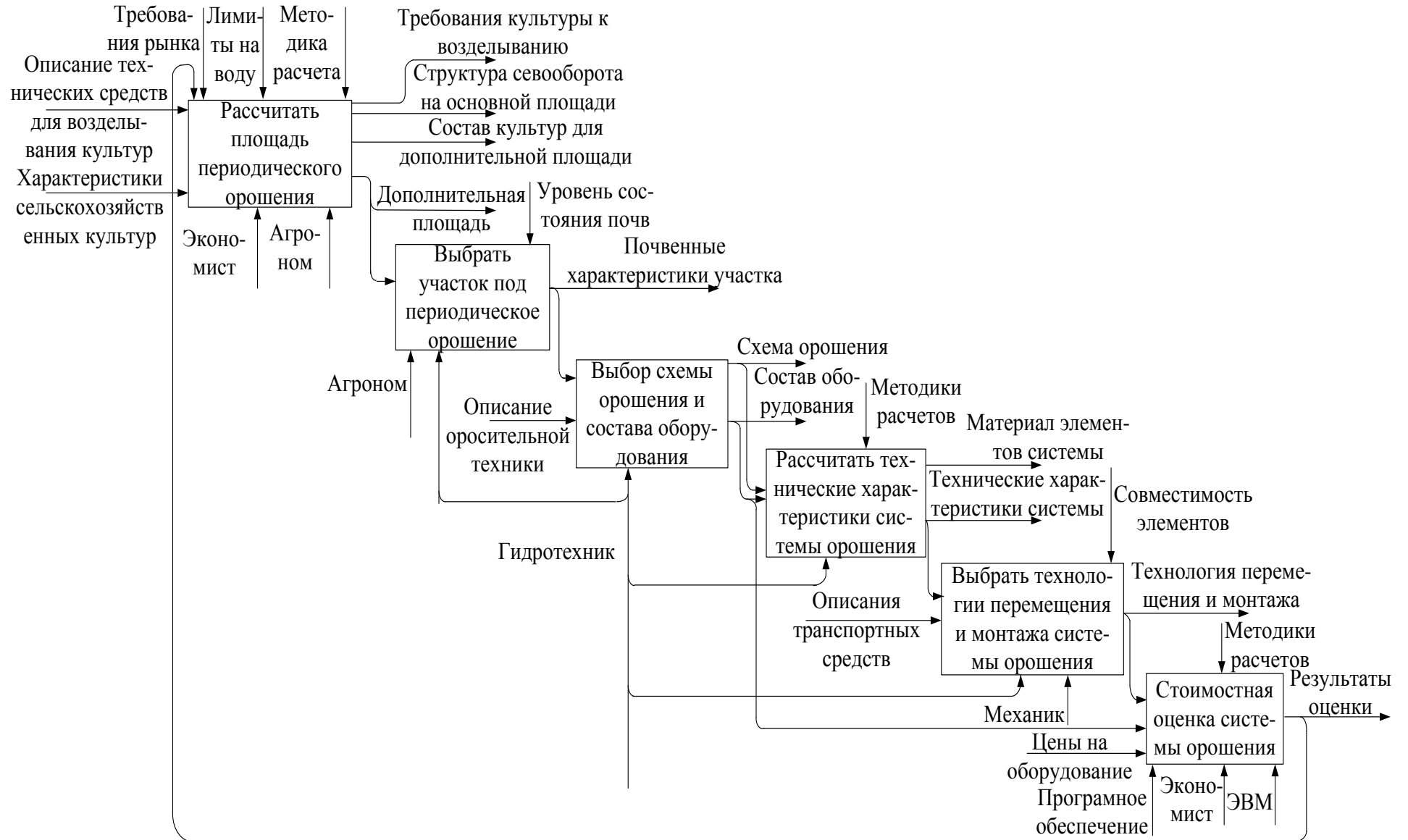
Рисунок 4 – Схема организации системы периодического орошения
